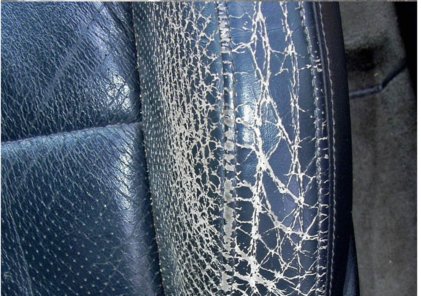
Stark brüchige Autoleder.
