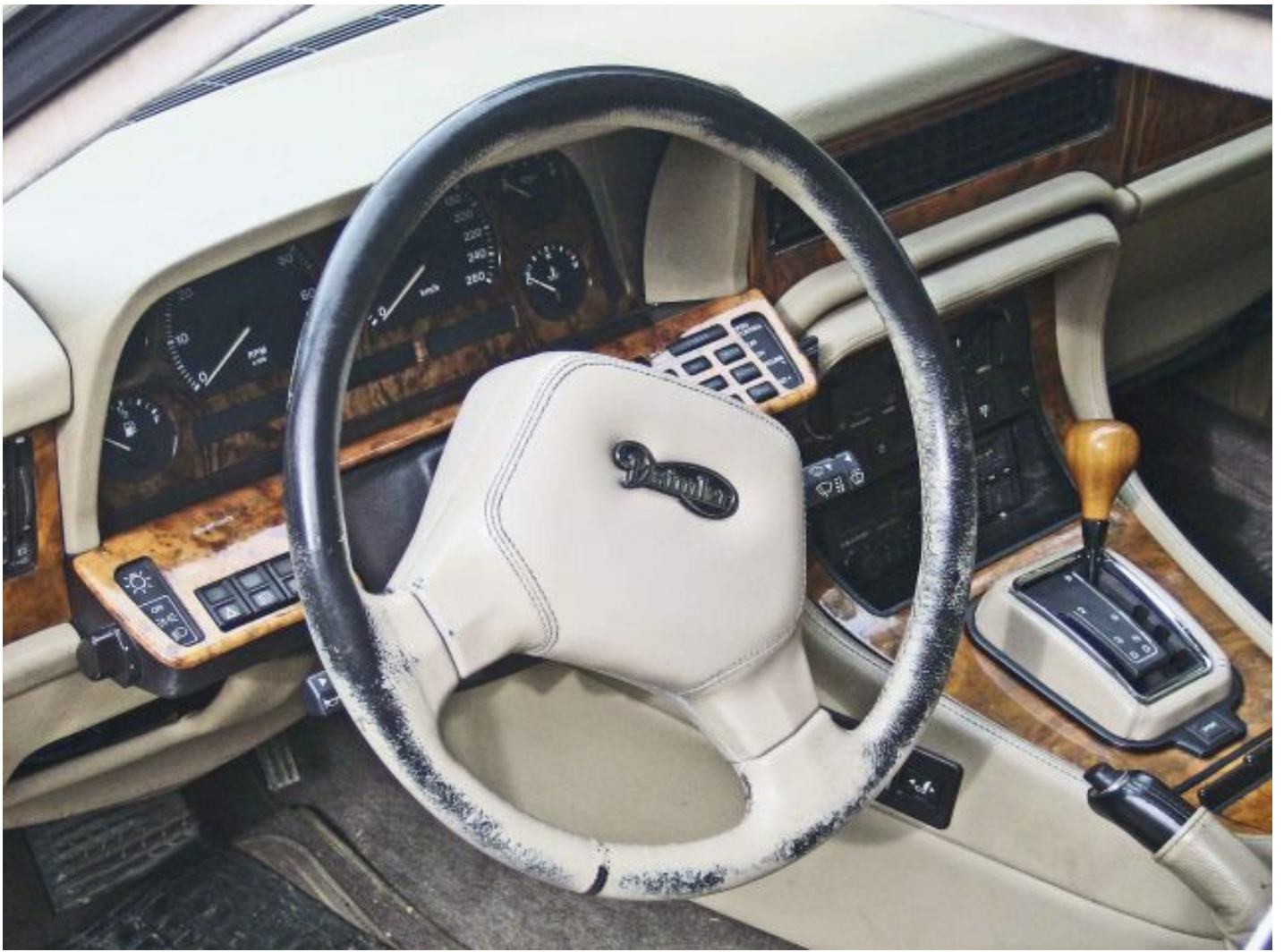
Extrem verfettet. Lieber Hilfe beim Fachbetrieb suchen oder neu beziehen lassen.
