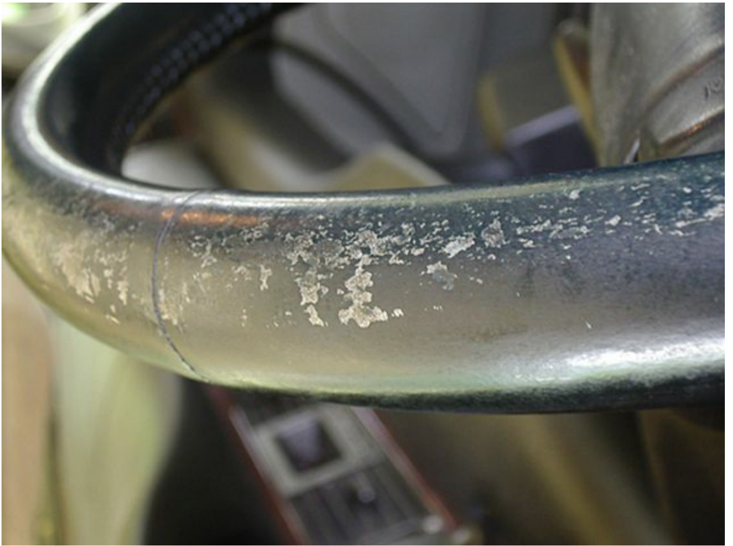
Aufgeraut: Schleifpad verwenden
